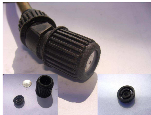
Figura 5. Bico de aspersão. Retirada do difusor em detalhe. Procedimento realizado para Técnica Usual avaliada no Capítulo II.
