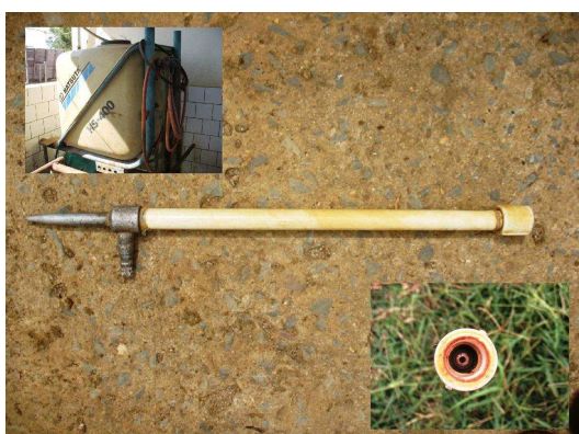
Figura 3. Equipamento utilizado para a técnica Usual avaliada no Capítulo I. Detalhe do equipamento improvisado: barra de aspersão, reservatório e orifício da ponta.
