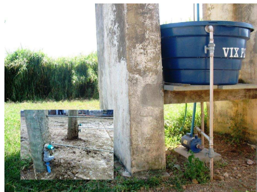
Figura 10. Equipamento utilizado para a técnica Pulverizador Estacionário Motorizado. Detalhe do reservatório, tubulação, motobomba e saídas laterais ao corredor de cordoalha.
