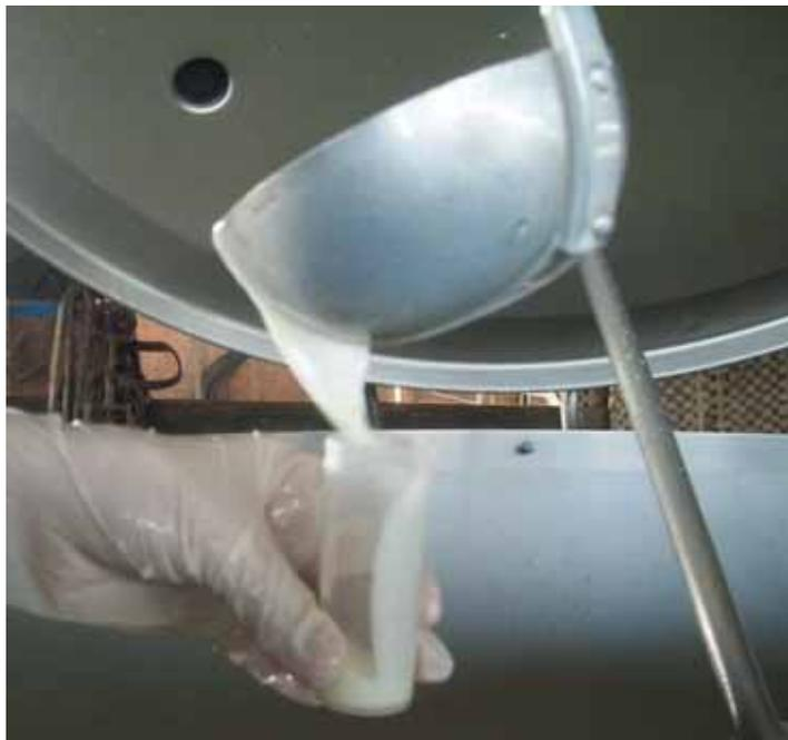
FIGURA 2. Colheita de amostra de leite bovino, a partir de tanque de expansão, utilizando concha de alumínio, estéril. Botucatu-SP, 2011.
