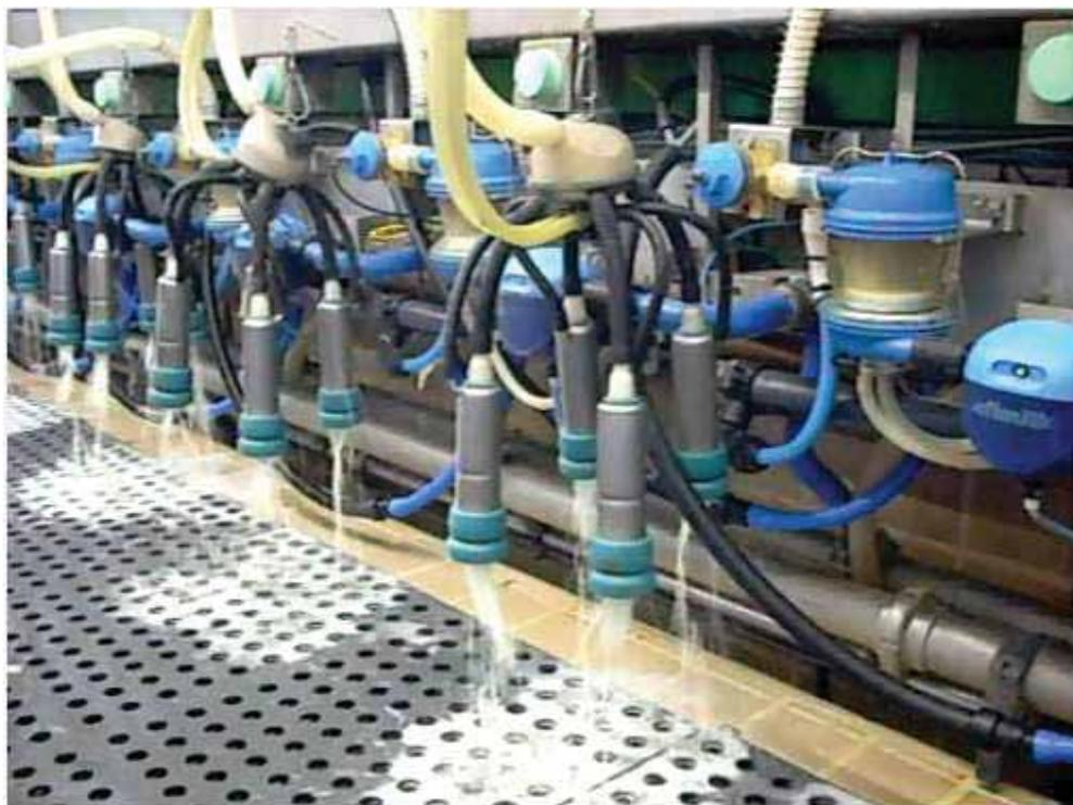
FIGURA 13. Procedimento de desinfecção *back-flushing* dos conjuntos de ordenha (sistema canalizado), realizado em uma das 20 propriedades avaliadas, localizadas no centro oeste do Estado de São Paulo. Botucatu-SP, 2011.
