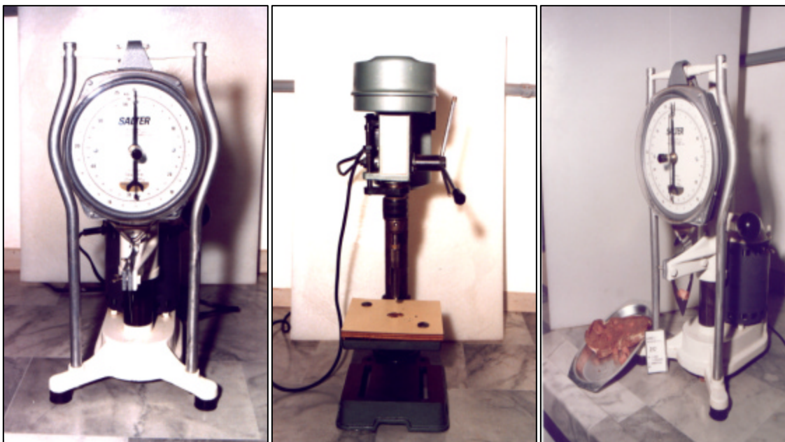
Figura 7 – Aparelho de Warner Bratzler Shear Force – Utilizado para medir a maciez da carne, Getulina, SP, 2002.
