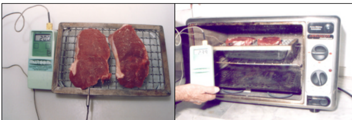
Figura 6 – Termoacoplador inserido no centro da amostra. e cozimento da carne em forno, Getulina, SP, 2002.
