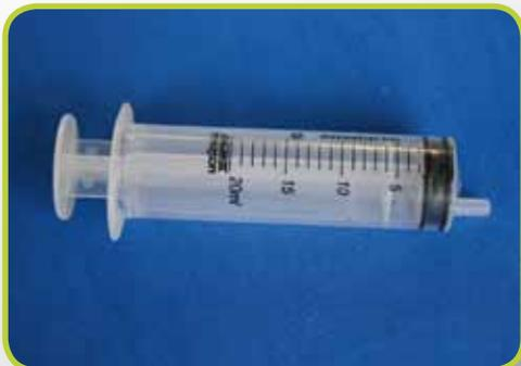
Seringa de 20 mL para medir a quantidade de cloro a ser colocada no balde de armazenamento de água clorada
