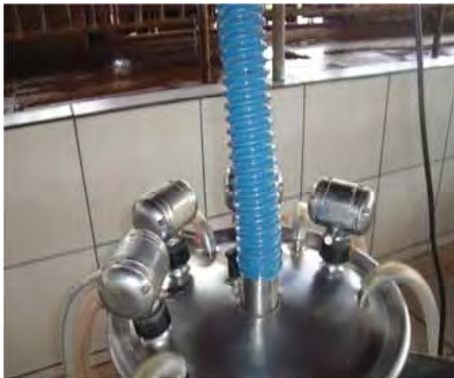
Legenda: Borracha do vácuo em azul, conectada a tampa do tanque de equilíbrio.
