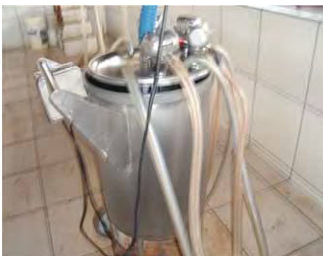
Legenda: Tanque de equilíbrio ou transferidor, demonstrando a tampa com as mangueiras e a borracha do vácuo conectadas.
