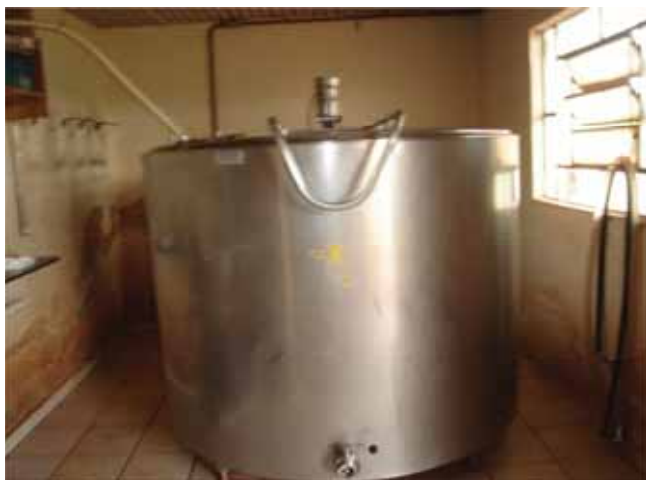
Legenda: Tanque de expansão, com refrigeração e capacidade para 10.000 litros pertencente a propriedade estudada.
