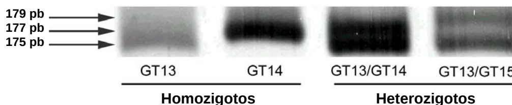
Figura 1. Resultado representativo do SSCA para identificação dos alelos do gene Nramp1 . As setas indicam produtos do tamanho 175, 177 e 179 pares de base correspondendo a GT13, GT14 e GT15, respectivamente.
