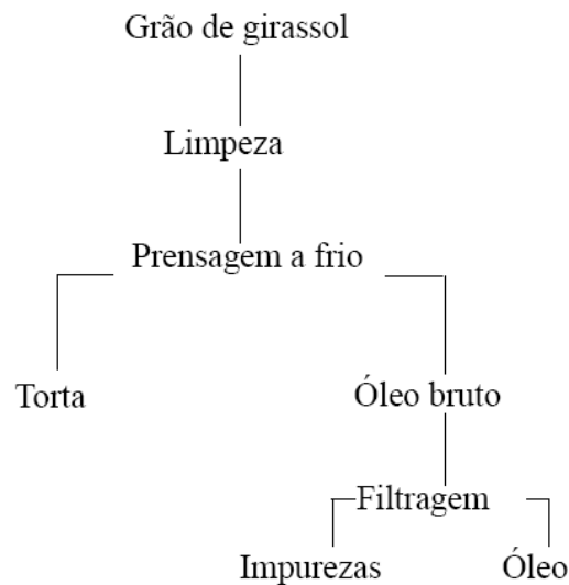
Figura 1: Fluxograma de extração da torta de girassol em pequena escala, em prensagem a frio utilizando miniprensa (OLIVEIRA et al., 2007).
