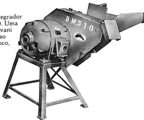
Este é o desintegrador Mantovani D 502, que trabalha acoplado a um motor estacionário ou a um trator.
