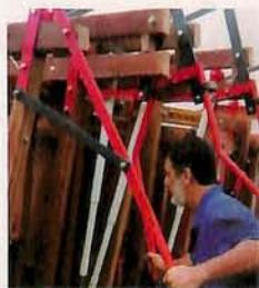
**PISTÕES** autotravantes **Hidra-lock®** fazem a contenção perfeita, ágil e segura do animal de qualquer porte ou idade.
