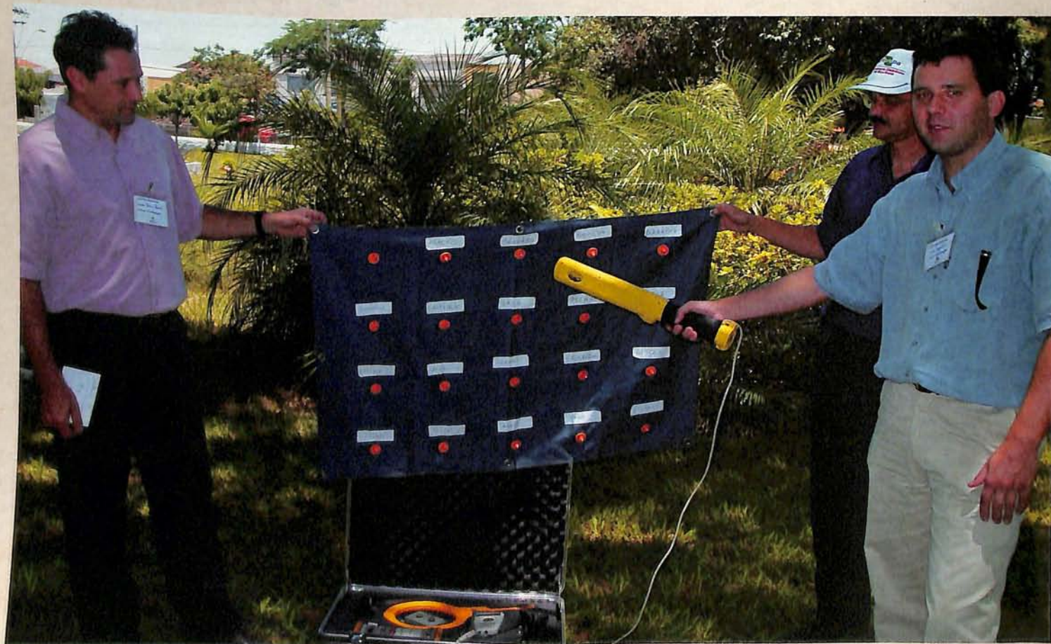
Técnico da Embrapa mostra o equipamento usado para fazer a leitura dos dados armazenados no chip que é introduzido no animal
