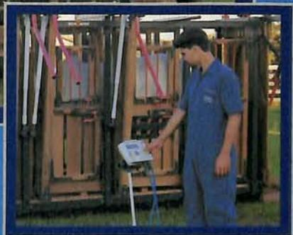
A montagem sobre chassi de aço permite acoplar balança eletrônica ao **Tronco Beckhauser 2002**, tornando-o um equipamento dois-em-um, o que agiliza a tomada de decisões, dá maior rapidez ao manejo, evita desperdício de medicamento e economiza espaço no curral.
