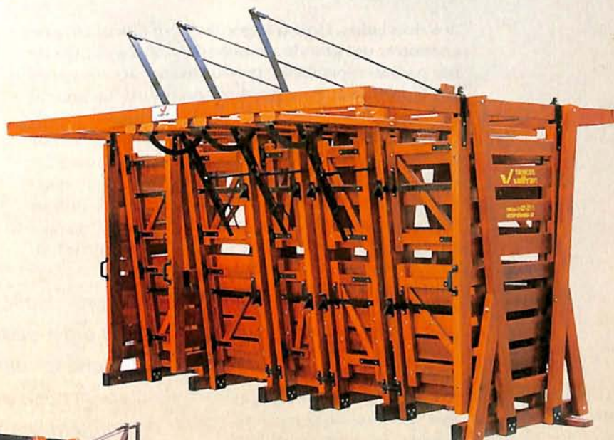
Tronco de Contenção
