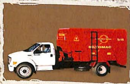
Misturadora de Ração acoplada ao chassi de caminhão
