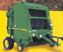
Enfardadora Cilíndrica 568 Tamanho do fardo: diâmetro de 813 a 1829mm, largura de 1565mm e peso máximo de 1100 kg.
