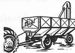
CARRÊTA TOTALMENTE METÁLICA. POSSUI DISPOSITIVO PARA DESCARGA DE CEREAIS
