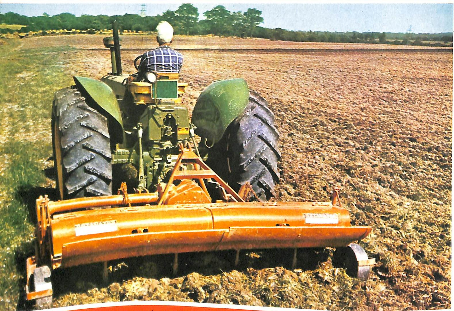
A mais recente inovação introduzida no trabalho mecânico do solo é a conjugação do ROTAVATOR com o SUBSOLADOR HOWARD, que acoplado na parte posterior da máquina rompe as camadas endurecidas do subsolo que constituem sério obstáculo à penetração das raízes e à retenção da água. A utilização do subsolador Howard permite que a camada
