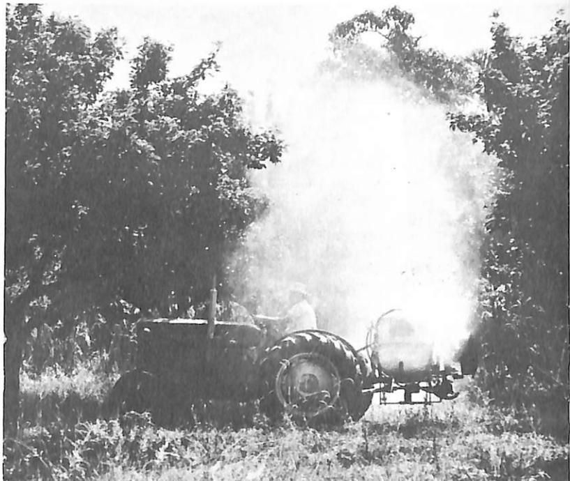
Pulverizador com turbo-hélice, utilizado na pulverização de pomares, algodão, café, etc.
