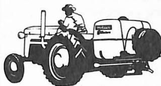
**Pulverizador TU-Turbo Hélice. C/exclusivo sistema injetor direto, que evita contaminação na fonte de abastecimento. Alcance perfeito de 8 m para cada lado. Tanque fiberglass transparente de 200 a 550 litros. Acoplamento em qualquer trator c/ levante hidráulico de 3 pontos. Produz 12000 m<sup>3</sup> de ar p/hora.**
