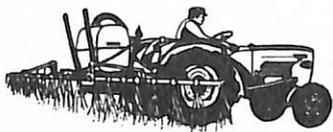
**Pulverizador ASB-40 c/barras de aspersão de 12 m, dobráveis c/dispositivo de retorno. Único com sistema injetor direto, que evita contaminação na fonte de abastecimento. Tanque fiberglass transparente de 200 até 550 l. Acoplamento em qualquer trator c/ levante hidráulico de 3 pontos.**
