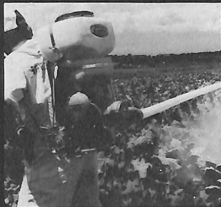
**ATOMIZADOR POLVILHADEIRA BLOWMIC AM-8 HATSUTA:** Aplica qualquer tipo de defensivo agrícola em qualquer cultura, a baixo e ultra-baixo volume (LVC) - Pó - Grãos. Equipado com motor de 2,8 HP a 7.000 RPM, é leve, resistente e econômico.
