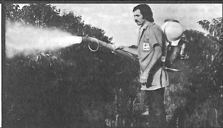
PJMD 45 B - PULVERIZADOR POLVILHADEIRA MISTO - MÚLTIPAS FUNÇÕES: PULVERIZA, POLVILHA, SEMEIA, APLICA ADUBOS GRANULADOS E LANÇA CHAMAS. NÃO PROVOCA VIBRAÇÕES NO OPERADOR E NÃO PREJUDICA SUA COLUNA DORSAL.
