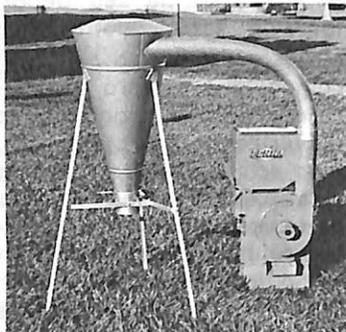
necessário desmontar parte da máquina. A manutenção e a limpeza nessa máquina são facilitadas porque elas são dotadas de uma abertura lateral para efetuar as duas operações.
