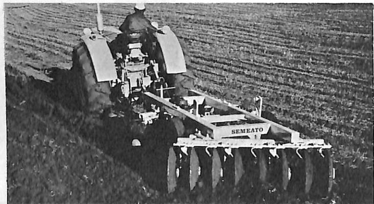
A Grade Semeato, tipo "Off-set" (series H-16, H-18, H-20 e H-24), produzida pela firmagaucho Semeato - Mecânica Agrícola Rossato Ltda., possui um sistema de engate no trator (modelo de arrasto) com pino giratório e levante hidráulico. A grade é dotada de duas molas helicoidais, uma superior e outra inferior,
