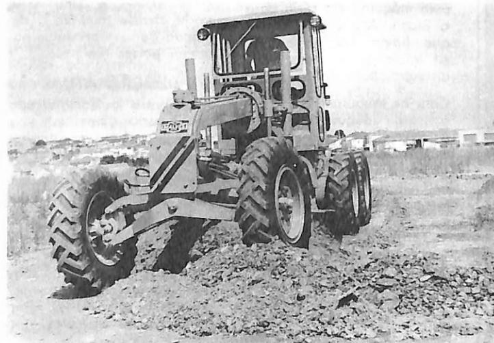
A MALVES S/A., fabricante de Tratores de Pneu, Esteiras e Motoniveladoras, estabelecendo melhoramentos em sua Motoniveladora equipou-a com Motor Mercedes-Benz OM-352 com 120 HP SAE e Peso de 11 000 Kgs.; transmissão 4x4 ou com redução 8x8; Escarificador
