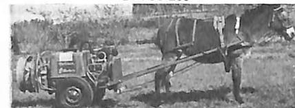
A carreta HOLDER/TRILHOTERO, também com turbo-hélice, para tração animal, destina-se à pulverização de plantações onde não há espaço para a movimentação de grandes tratores. Tanque para 200 litros. Alcance de 8 m para cada lado. Produz 12.000 m<sup>3</sup> de ar p/hora.
