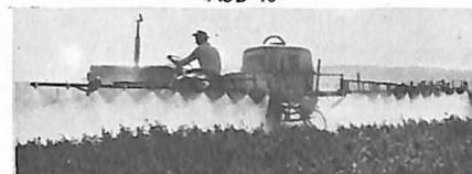
Este modelo foi especialmente projetado para a pulverização de lavouras baixas. Possui barras de aspersão de 6, 8, 10 e 12 m, dobráveis, com dispositivo de retorno. Tanque de fiberglass para 200 até 400 litros. Distância entre esguichos: 50 cm.
