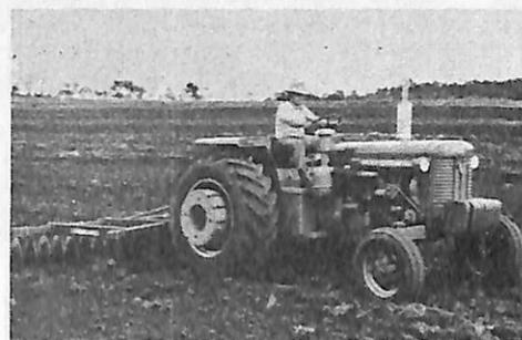
A Massey-Ferguson produz também implementos para seus tratores; na foto, um MF 95 tração uma grade pesada MF.
