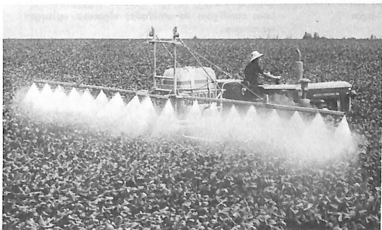
**PJ 500 - PULVERIZADOR** - APLICAÇÃO DE DEFENSIVOS EM CULTURAS EXTENSIVAS DE BAIXO E MÉDIO PORTES. LEVANTAMENTO DE BARRAS ATRAVÉS DE ACIONAMENTO MECÂNICO.
