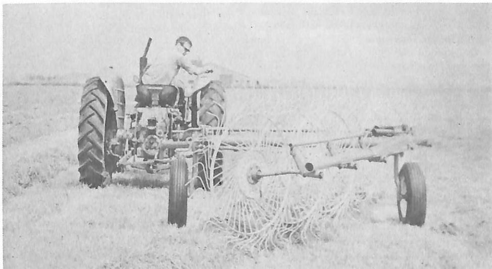
Esse implemento é um revirador-enleirador completamente montado e adapta-se à maioria dos tratores que dispõem de três pontos. A sua grande capacidade de trabalho permite que o lavrador tire proveito do estado do
