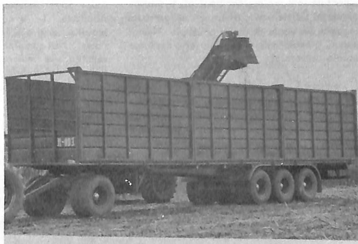
SEMI-REBOQUE 3 EIXOS - TRANSPORTE DE CANA
