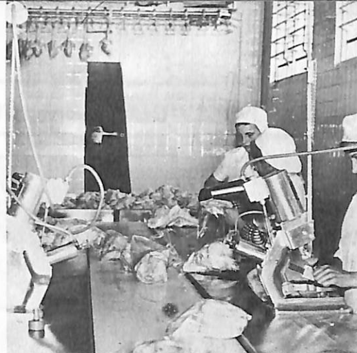
Mesa de embalagem com esteira transportadora, onde as aves são embaladas em sacos plásticos e lacradas
