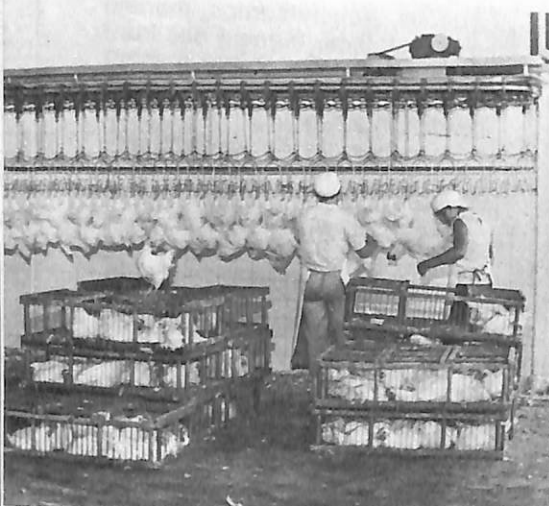
Início da operação, totalmente, automatizada: colocação das aves na linha de matança
