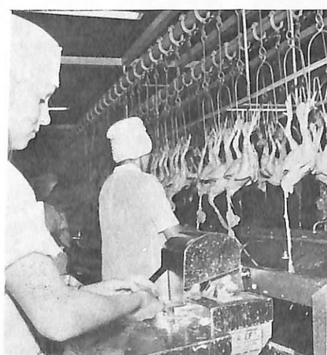
Limpador de moelas, em funcionamento, na linha de evisceração Madef
