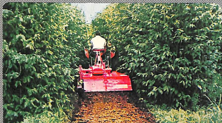
ROTAVATOR CAFEIEIRO - EP-50 - Trabalhando em cafezal com o trator bitola estreita.
