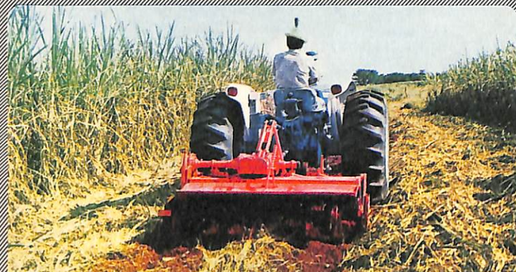
ROTAVATOR CANAVIEIRO ERP-50 - especial para aparação e destruição da soqueira.
