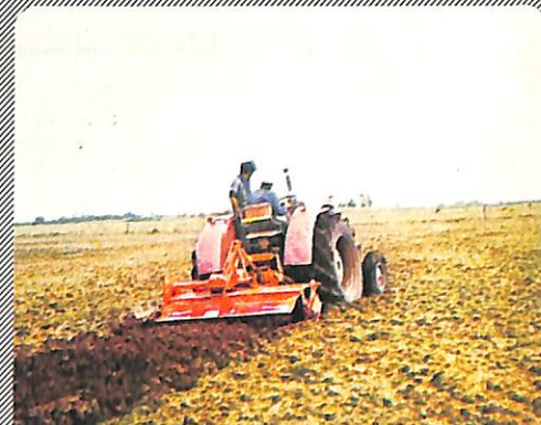
ROTAVATOR STANDARD - EP-60 Para trabalhos gerais leves de cultivo e aração superficial.
