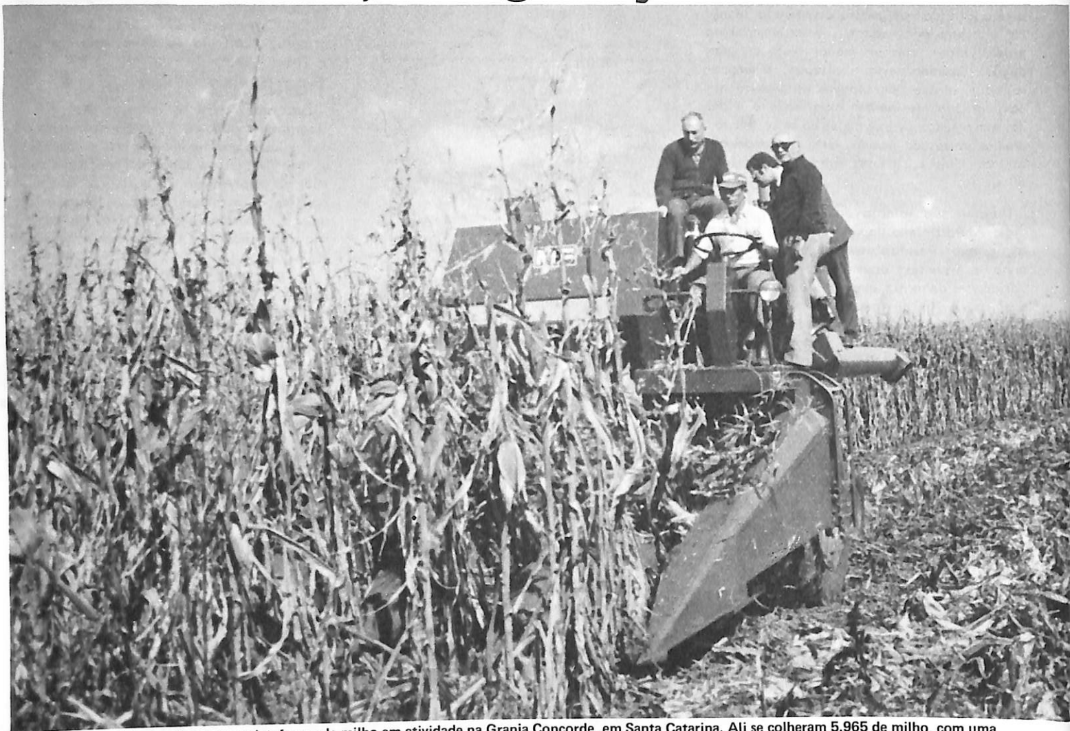
Colheitadeira equipada com plataforma de milho em atividade na Granja Concorde, em Santa Catarina. Ali se colheram 5.965 de milho, com uma média de 70 sacos p/ha.
