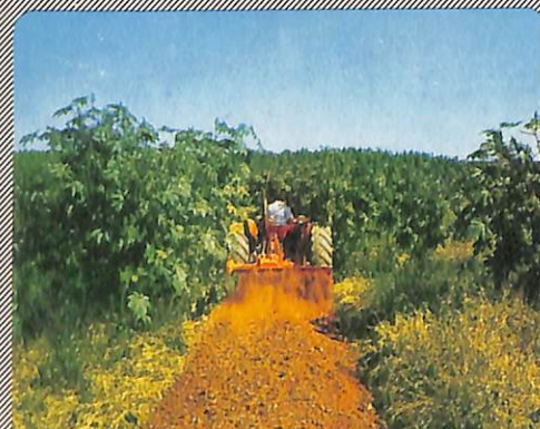
ROTAVATOR STANDARD - E-50 Para serviços gerais pesados de aração, gradeação e incorporação.
