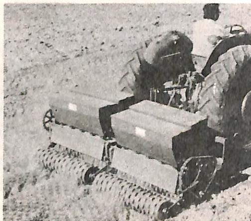
Um lançamento recente de Máquinas Natal que possibilita desfrutar de pastagens 60 dias após a germinação. Semeia e aduba numa única operação e possui depósitos independentes para a semente e o adubo. Incorpora o adubo ao solo, através de um rolo, além de compactar a semente.
