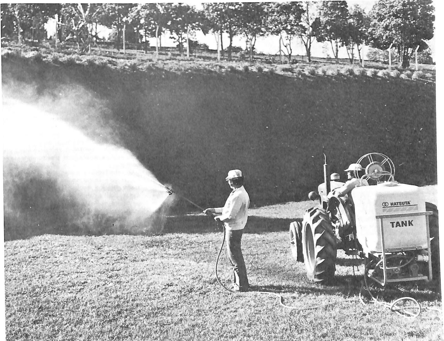
Pulverizador hidráulico da Hatsuta
