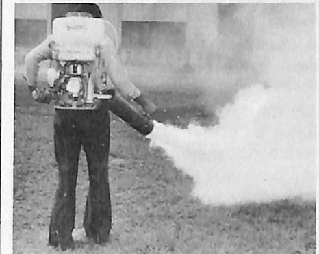
Um atomizador que também é pulverizador, polvilhadeira e lança-chamas, que dotado de um tubo de descarga extra se transforma num aparelho de combate aos mosquitos, eis o versátil lançamento da Hatsuta do Brasil S.A., denominado AM-12.
