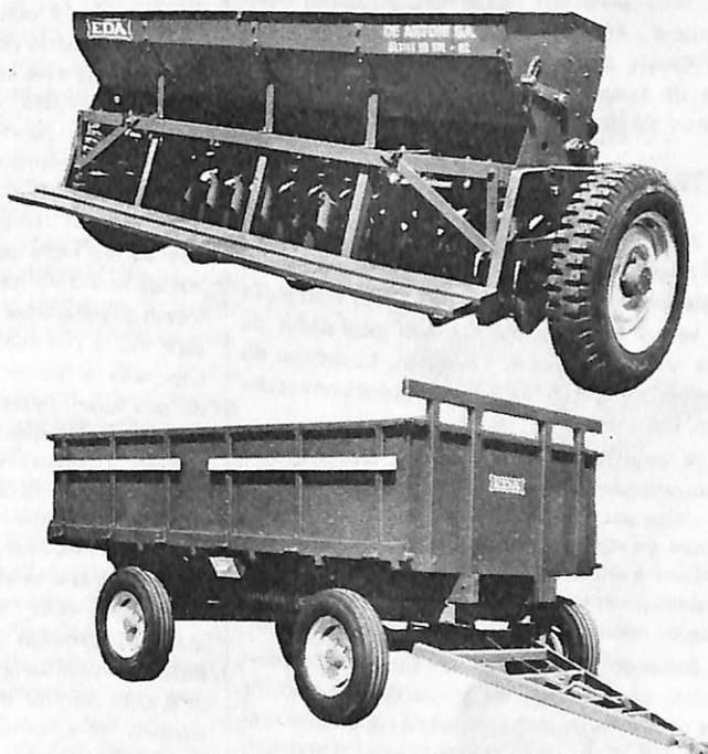
SEMEADEIRA ADUBADORA EDA é resistente. Componentes mecânicos em ferro fundido cinzento nodular. Chassi de aço. Depósito de adubo e sementes em aço inoxidável. Em cinco modelos: 8, 10, 13, 16 e 17 toneladas.
