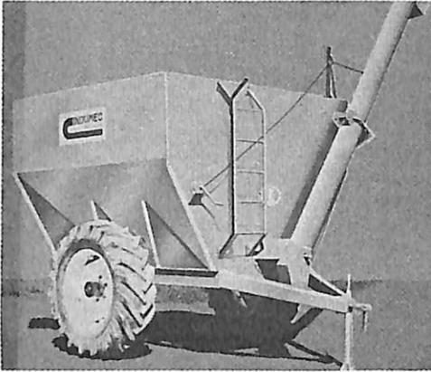
A Indumec-Indústria Mecânica Ltda. está anunciando a Carreta Graneleira, acionada pela tomada de força do trator e cuja capacidade de carga é de 90 sacos, que descarrega em 3 minutos. Dotado de válvula para descarga inferior por gravidade e com boca de descarga para encaixe opcional, o implemento pode utilizar pneus de trator ou avião, sendo apresentado, também na versão de 2 eixos, em modelos para 7 e 12 t. Rua Marcílio Dias, 1905, Pelotas, RS.
