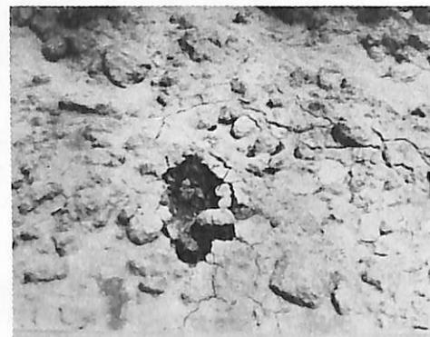
**Fig. 3 - Acima, crosta de argila, quase sem vegetação. Ao centro, crosta em terreno argilo-arenoso com numerosas fendas. Embaixo, crosta quebrada por uma pisada em terreno limoso. Nesta, quase não há fendas**
