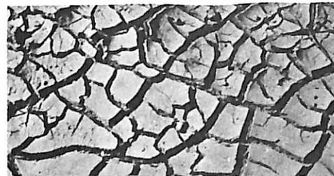
**Fig. 6 - Crosta argilosa típica de barro dessecado**
