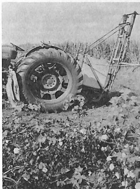
Fig. 3 - O tratamento fitossanitário deve ser feito com tratores de eixo alto e com tanques de grande capacidade
