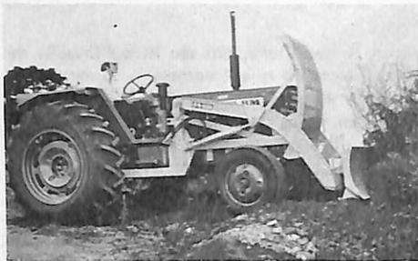
A Madal S/A Implementos Agrícolas e Rodoviários acaba de lançar no mercado paraguaio a Plaina Frontal Desmate, para tratores Volvo, conforme mostra a foto. A plaina é acionada com o sistema hidráulico Madal, engrenagens acopladas ao virabrequim e feitas de aço ASTM - A283.
