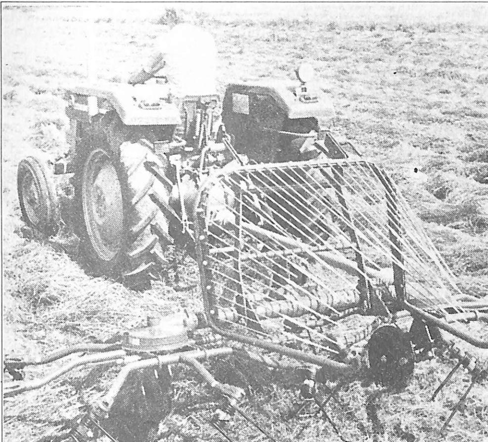
Fig. 35 - Ancinho de revolvimento com sistema de enleiramento
