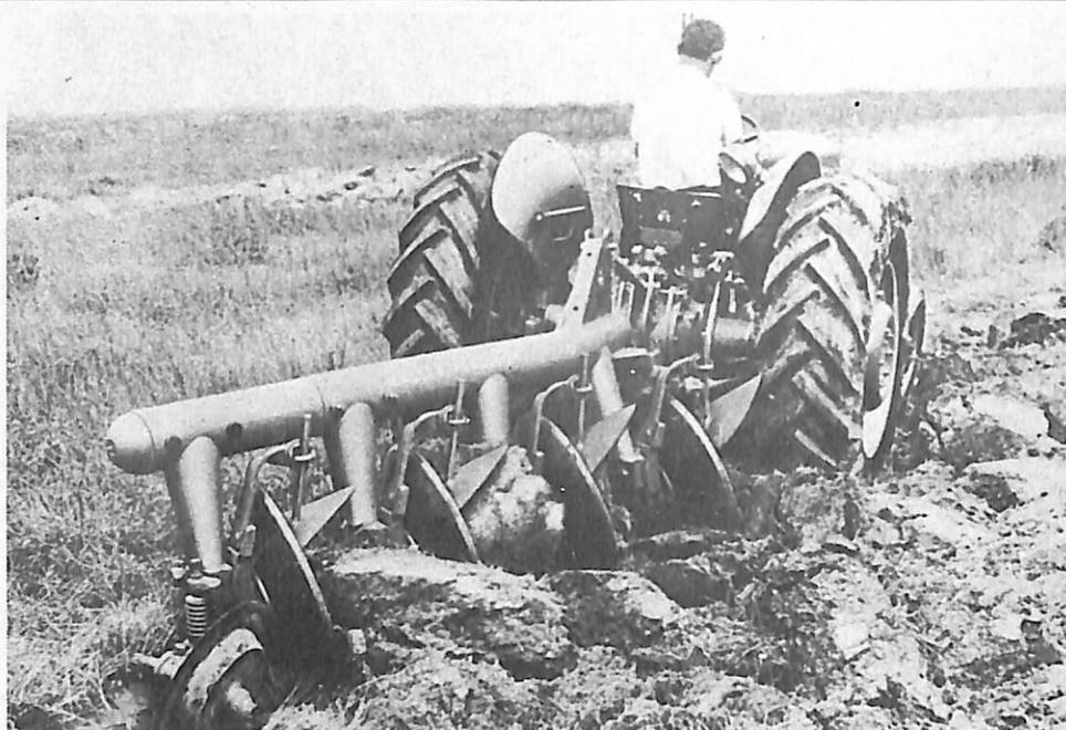
Fig. 13 - Arado de disco em trabalho, destacando-se a cobertura do terreno
