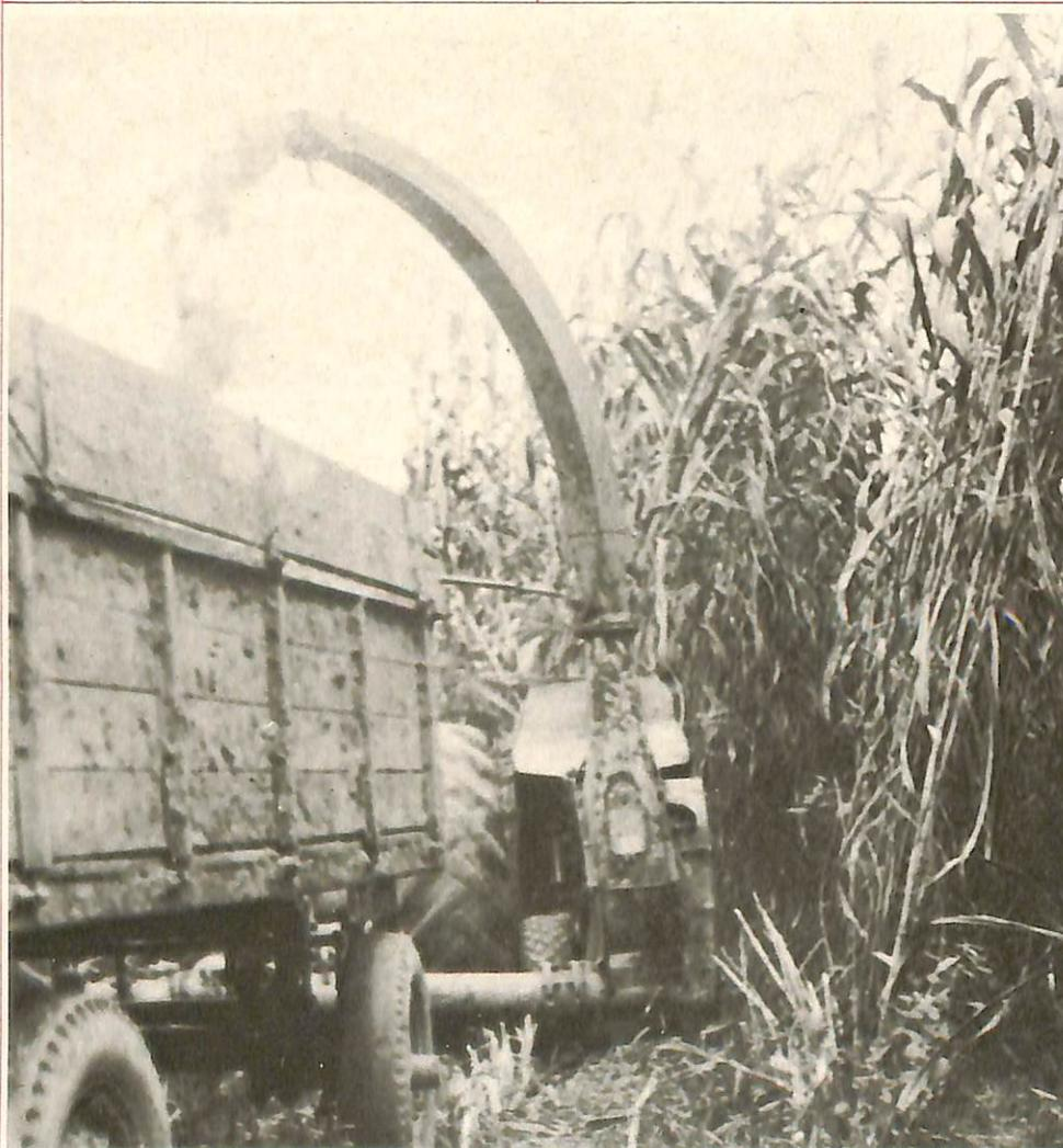
Fig. 33 - Colheitadeira de forragem tipo tambor com facas de corte, em plena operação
