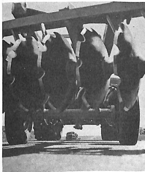
Em modelos de 12, 14 e 16 discos, foi lançada no mercado a Grade Aradora Leve Super Tatu, um produto da Marchesan Implementos e Máquinas Agrícolas Tatu S/A - rua Bambozzi, 430, Matão, SP. O implemento foi projetado para ser usado em tratores médios, e utiliza um leve chassi tubular especialmente dimensionado para reduzir o esforço da tração. Pode ser empregado em qualquer tipo de solo e, graças ao feixe de molas de lâminas acoplado à barra off-set, a grade acompanha as ondulações do terreno.
