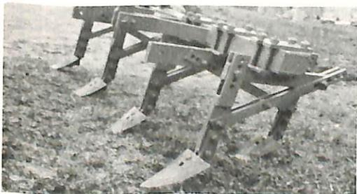
Fig. 2 - Cultivador de coluna rígida
