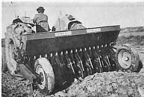
A Semeato S/A, caixa postal 559, Passo Fundo, RS, lançou a LV 3 PT G13 18 linhas, semeadeira adubadeira de levante hidráulico, especial para a lavoura de arroz irrigado e trigo. É dotada de discos duplos e retos, trabalhando com espaçamento entre-linhas de até 120 mm.
