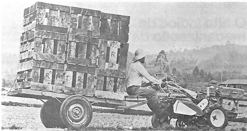
Fig. 17 - Plataforma transportadora, montada em sistema de engate de 3 pontos
