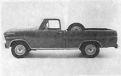
A Ford do Brasil comunica o lançamento do novo Pick-Up F-100, com motor de 4 cilindros, com 99 CV, cabine mais espaçosa e bitola traseira mais larga, proporcionando melhor estabilidade. O modelo 1977 do F-100 tem 3 versões de acabamento e 5 novas cores, além de um desempenho semelhante ao modelo de motor V-8, com a nova caixa de 4 marchas e redução do diferencial. Av. Dr. Rudge Ramos, 1501, São Bernardo do Campo, SP.
