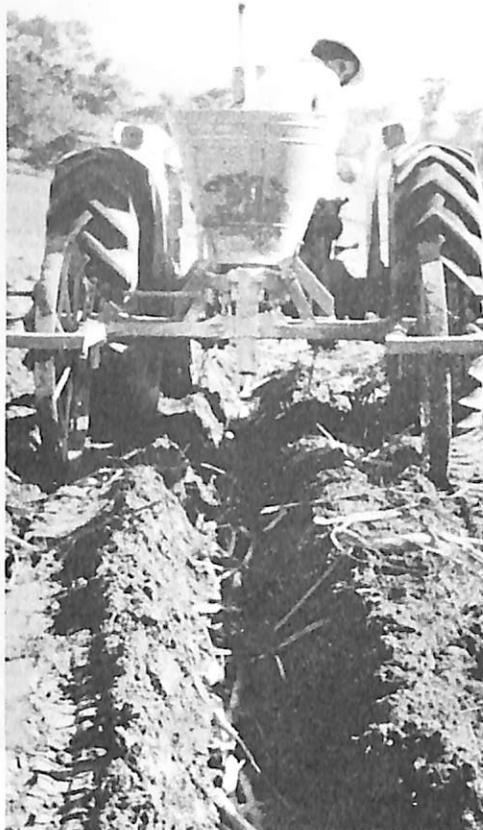
Em mecanizações leves de cana-de-açúcar, as adubações são feitas depois da colocação das mudas numa operação complementar
