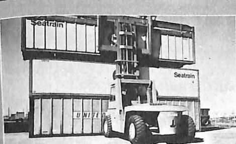
Já está no mercado o Top Pick-Up Containers Handler, equipamento que pode ser adaptado nas empilhadeiras CY-525 e CY-700, capacitando-as a transportar containers com peso de até 30.351 kg. A novidade é apresentada pela Equipamentos Clark S/A, Via Anhangüera, km 84, Valinhos, SP.
