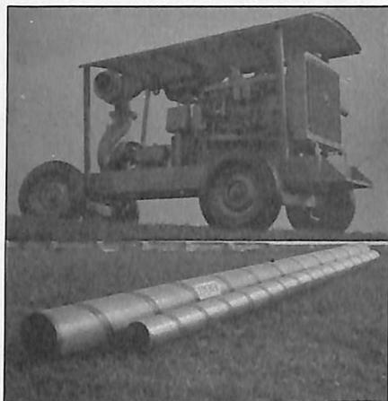
Conjunto moto-bomba com motor diesel Mercedes-Benz de 180 HP. Capacidade 500 m<sup>3</sup> por hora.
