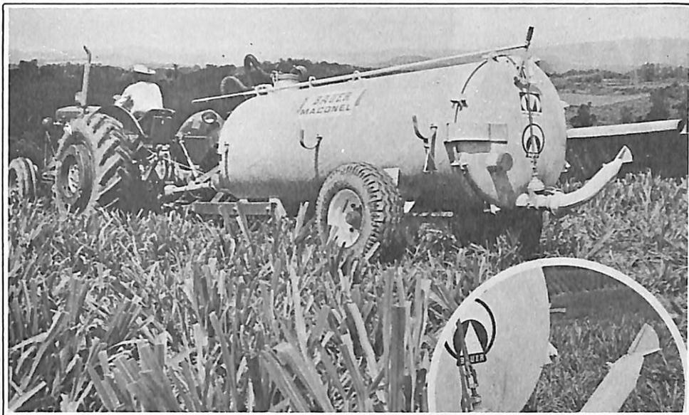
Utilizado para a distribuição do "Chorume" (água de lavagem dos estábulos + fezes + urina) nos campos de cultura e pastagens, o Distribuidor de Esterco Líquido Bauer Maconel é tracionado por trator, e com compressor acionado pelo eixo cardan, através da tomada de força. De dois estágios, o compressor cria vácuo e pressão dentro do tanque, permitindo respectivamente a sucção do material captado em fossa e a aspersão no campo através de dois bicos asper-
