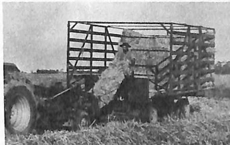
A Carreta de Fenação Masal, produzida pela Máquinas Agrícolas Santo Antonio Ltda, possui capacidade para até 5.500 kg ou 300 fardos de 15 a 18 kg cada. Própria para transporte de fardos na lavoura, o implemento pode ser facilmente desmontado e utilizado para diversos tipos de carga. O mecanismo de acoplamento - fabricado para qualquer tipo de enfardadeira - consta de calha e engate que acompanha a carreta. Rua Alfredo Caetano, 2, Santo Antônio da Patrulha, RS.
