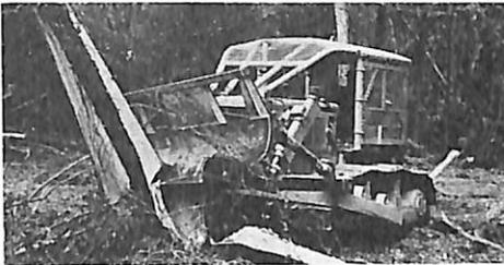
A Nicola Rome Máquinas e Equipamentos S/A colocou no mercado, para uso em serviços de desbravamento de florestas, a Lâmina Rome KG totalmente construída em aço. Com borda cortante e esporão substituíveis, a Lâmina - que deve ser montada nos tratores Caterpillar D6C - trabalha na derrubada de árvores, destoca e empilhamento de materiais, construindo valas de drenagem e estradas de acesso.
