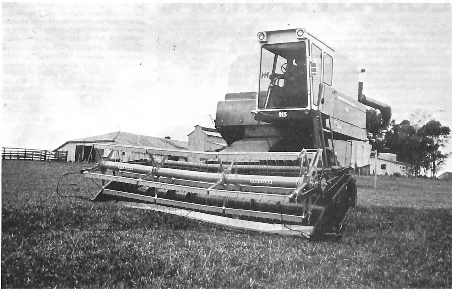
Colheitadeira equipada com Molinete G-80 e Barra de corte Flexível e Flutuante FLEXIBAR
