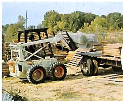
Sempre você descobrirá novas utilidades para o Bobcat com pallet. Ele tira ou coloca uma carga até numa altura de 2,60 m.
