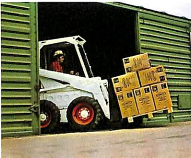
Com os garfos para pallet, Bobcat se torna indispensável na área de movimentação de cargas, descarregando e carregando caminhões ou vagões de mercadorias.
