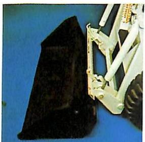
encaixar o suporte (Bob-Tach) na caçamba, usando para isso os controles da máquina;
