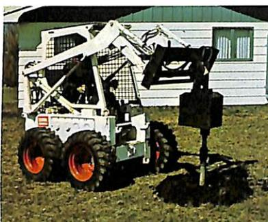
Acoplado a broca, Bobcat vai perfurar o solo para a colocação de postes, mourões de cerca, árvores, etc.
