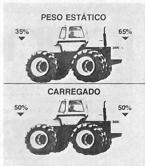
Quando se acopla um implemento, a carga se distribui uniformemente nas quatro rodas. O trator isolado tem 65% do peso dianteiro e 35% no traseiro
