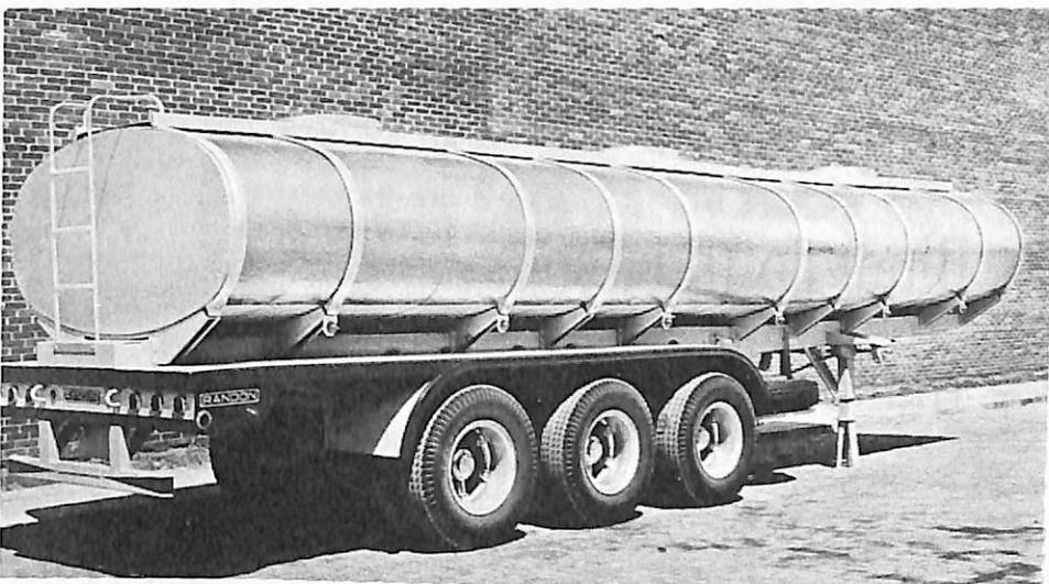
O modelo SRT-3-23.000 IISL, do semi-reboque tanque inox isotérmico, fabricado pela Randon S.A. tem capacidade para um volume de 23.000 l, e vem equipado com eixos passantes, dimensionados em função da carga máxima e dos esforços solicitantes; freios a ar comprimido, de 8" para caminhões pesados, 7" para caminhões médios e de 5 1/2" para
