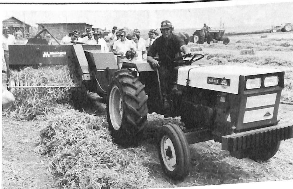
colhimento desse material, prensando-o e amarrando-o para ser armazenado e consumido pelo gado na época necessária. Essas máquinas contam com serviço de peças e manutenção, que cobre todo o território nacional.
