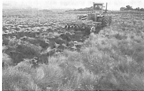
Devido ao seu elevado peso as grades usadas nos supertratores devem ser rodas pneumáticas, acionadas por cilindro hidráulico para facilitar manobras e o transporte.
