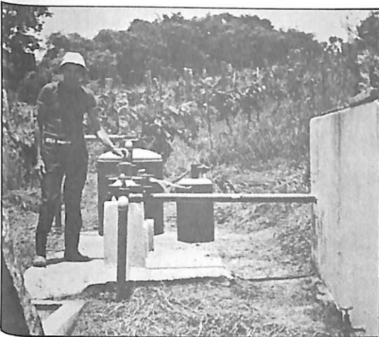
**Cabeçal de controle para filtrar a água, regulando a pressão do sistema. Mede a vazão da área e a adubação**
