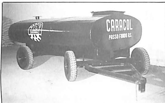
A carreta fabricada pela Caracol tanto pode ser utilizada para carregar água como líquidos ou combustíveis em geral. Apresenta capacidade de 4.500 litros, tanque ovalado e vem dotado de quebra-ondas internas. É equipado com rodas especiais e chassi reforçados. Mecânica Caracol, Av. Major João Shell, 685, Passo Fundo, RS.
