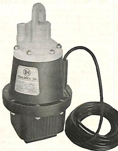
**BOMBA SUBMERSA** – O equipamento é recomendado para alturas manométricas superiores a 10 metros. Fabricada nas tensões de 110V e 220V e nas frequências de 50 Hz e 60 Hz, a Bomba Submersa é fornecida com cabo de alimentação de 8 metros. A vazão de litros/hora varia entre 1560 a 10 metros e 660 a 60 metros. Kohlbach S/A Indústria de Máquinas Elétricas, rua Presidente Epitácio Pessoa, 1333, caixa postal D-5, CEP 89250, Jaraguá do Sul, SC.
