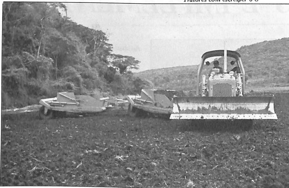
A movimentação de determinado volume de solo pode ser efetuada com lâminas ou escrêiperes. Em caso de micronivelamento, recomenda-se a plaina.
