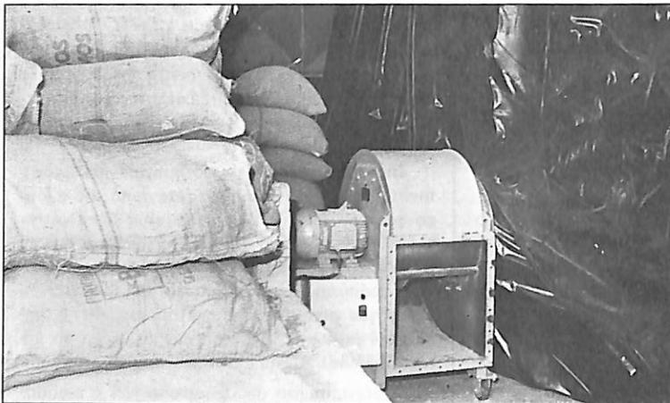
*Devidamente ensacados, os grãos têm sua umidade retirada por ventiladores de alta pressão*
