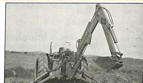
**BRAÇO VALETADOR** – O equipamento foi feito para executar trabalhos pesados na agricultura, apresentando uma estrutura reforçada. Suas sapatas hidráulicas são móveis, erguendo qualquer trator. O radiador dotado de ventilação a ar evita que o óleo se aqueça excessivamente. **Imap – Metalúrgica Agrícola Pitangueiras Ltda.**, rua João Manoel Fernandes, 165, caixa postal 35, CEP 95.500, Santo Antônio da Patrulha, RS.
