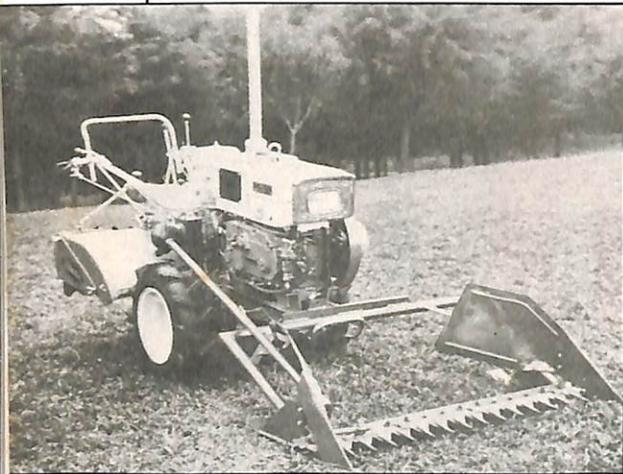
**SEGADEIRA** – A segadeira Mec-Rul, acoplada ao microtrator Tobatta, executa trabalhos de corte de qualquer tipo de gramíneas, leguminosas e pastos em geral. Também é utilizada para a limpeza de pomares, podendo cortar sob a copa das árvores. O modelo tem 120 centímetros de largura de corte, peso de 72 quilos, descentralização de 30 centímetros e 600 facas-golpes por minuto. **Metalúrgica Rugeri Mec-Rul Ltda., BR-116, km 153,2, caixa postal 197, CEP 95.100, Caxias do Sul, RS.**
