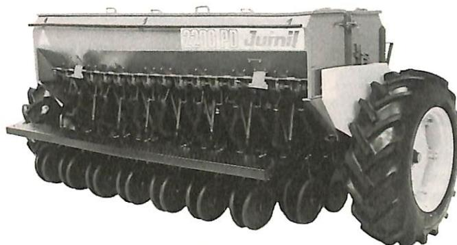
JM-2200 PD montada com 15 linhas para semeadura de grãos miúdos
