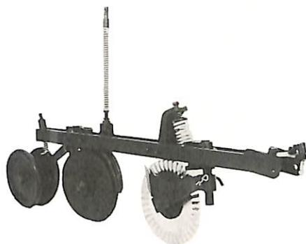
Unidade semeadora para grãos miúdos dotada de disco estriado cortador pivotado
