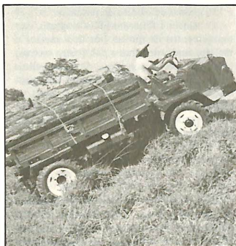
3ª GERAÇÃO – O modelo TTA-Paturle, de acordo com o fabricante, é o único trator transportador agrícola tipo universal, de terceira geração, fabricado no Brasil. O TTA possui motor Perkins 3.152 diesel, três cilindros, potência de 42,7 cv a 2200 rpm, torque máximo de 15,7 mkgf. Muito robusto, de fácil manutenção e baixo consumo de combustível. Artefatos Hércules S.A., Rua 2, 310, CEP 32200, Contagem, MG.
