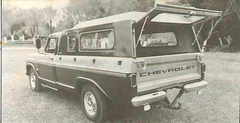
**CAPOTA** – A capota para pick-up Ford ou Chevrolet tem o exclusivo sistema Dino de fixação, dispensando a necessidade de furar a lataria. A vedação é absoluta, inclusive nas janelas corrediças. É construída em monobloco, de plástico reforçado e fibra de vidro. **Fibras Dino Ltda., Rua Guia Lopes, 1.349, Bairro Rondônia, CEP 93300, Novo Hamburgo, RS.**
